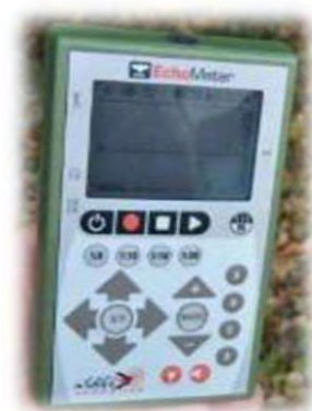
Figure 11 : Détecteur-Enregistreur d'ultrasons Echometer 3 (EM3) de chez Wildlife Acoustics
